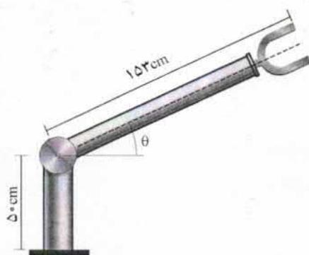
مثال: روبات‌ها در زمینه‌های مختلف کاربرد دارند. در طراحی انواع روبات‌ها از توابع مثلثاتی استفاده می‌شود. در شکل روبه‌رو یک روبات صنعتی را که در صنایع خودروسازی کاربرد دارد مشاهده می‌کنید. با توجه به مقادیر داده شده، ارتفاع نوک گیره روبات را از سطح زمین به کمک یک تابع مثلثاتی مدل‌سازی کنید.  $(0^\circ \leq \theta \leq \frac{\pi}{2})$
