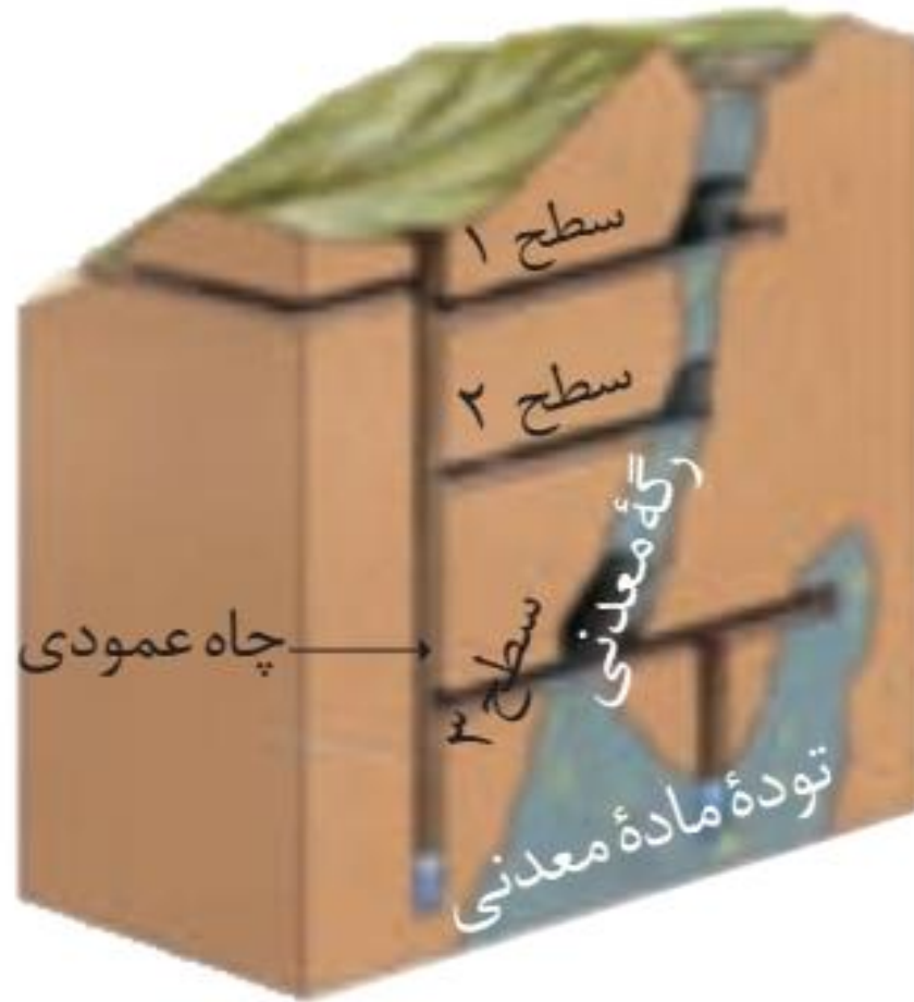
شکل ۸-۲: نحوه بهره برداری از معادن زیرزمینی
